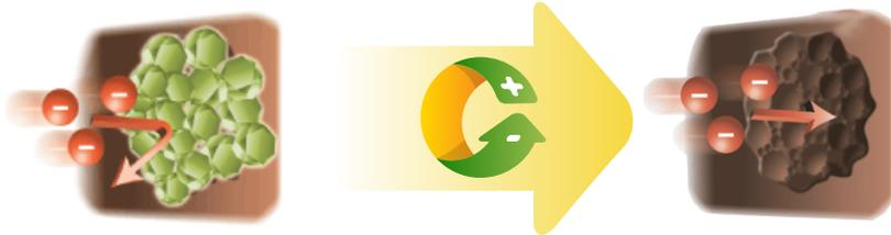
MACBATEC Midi regenera las baterías mediante pulsos de corriente totalmente controlados que de manera eficiente y de forma suave convierten los cristales inactivos en material activo. El proceso MACBATEC se controla de forma totalmente automática, disponiendo también de una función manual para su uso por profesionales. El mantenimiento MACBATEC se aplica de forma anual o bianual en función del uso que se le dé a la batería.
